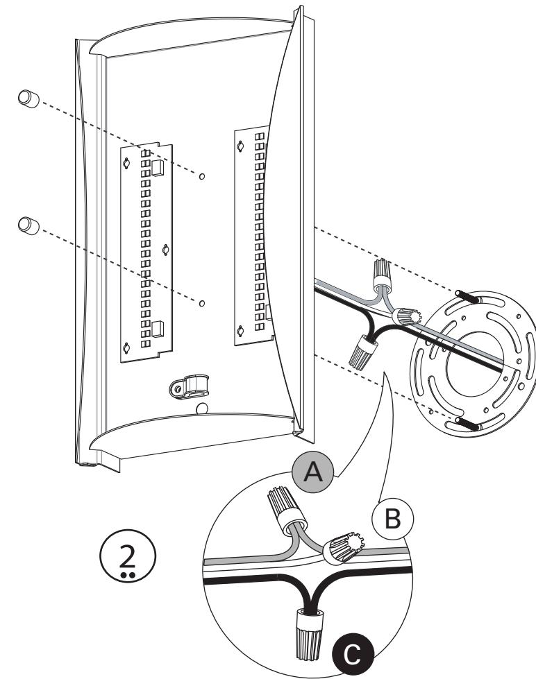
A. Fixez le fil de terre en cuivre à la mise à la terre. S'il n'y a que deux fils qui sortent de la boîte de sortie électrique, fixez le fil en cuivre de l'appareil d'éclairage à la vis de terre en vert de la Barre Transversale.
